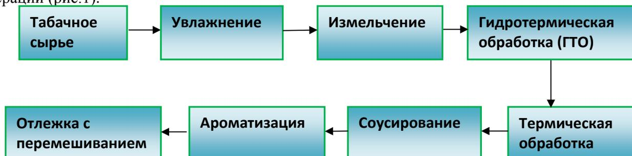
Рис. 1. Схема изготовления кальянных смесей
