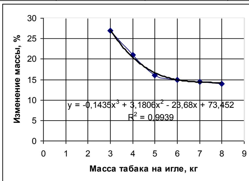
Рис. 3. Потеря массы табаком в процессе томления в зависимости от плотности размещения
