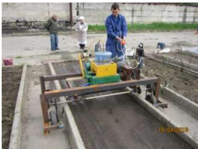
Рисунок 5. Технологический процесс гидравлического посева семян в паниках
