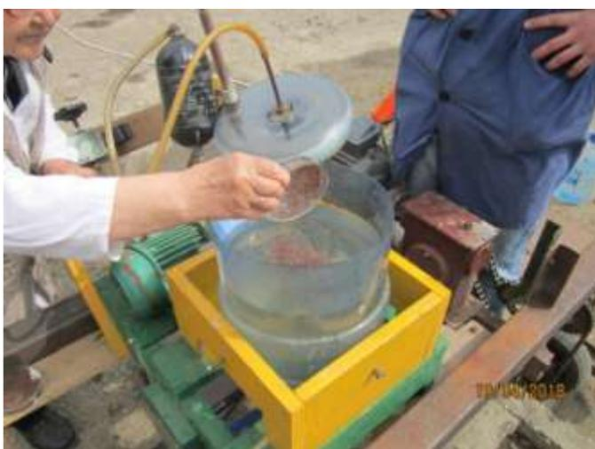
Рисунок 3. Технологический процесс заправки бака семенами
